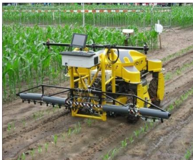
Attrezzatura high-tech per trattamenti di precisione 'Hortibot'. © Aarhus University, Denmark
